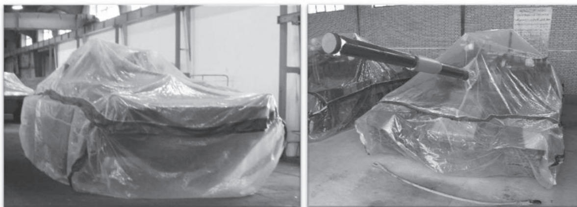
شکل ۴- انبارش بلندمدت دستگاه زرهی تانک (در سوله یا زیر چادر برزنتی) به روش تمام چادر
