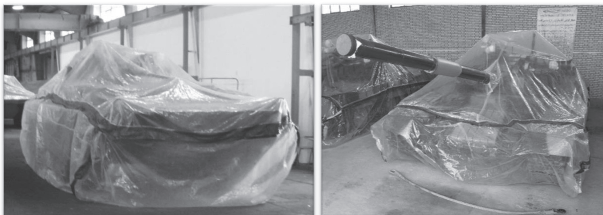
شکل ۴- انبارش بلندمدت دستگاه زرهی تانک (در سوله یا زیر چادر برزنتی) به روش تمام چادر
