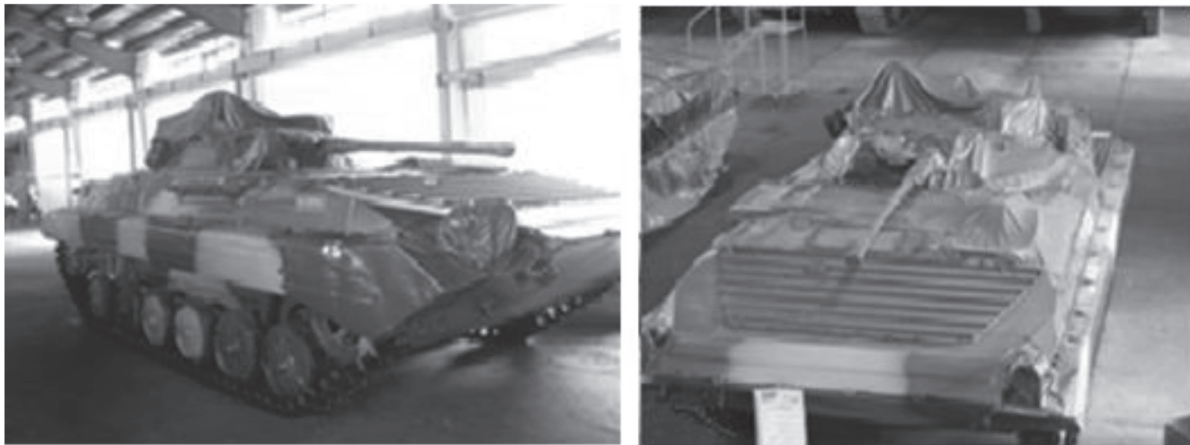
شکل ۲- نگهداری عملیاتی به روش چسب کاری
