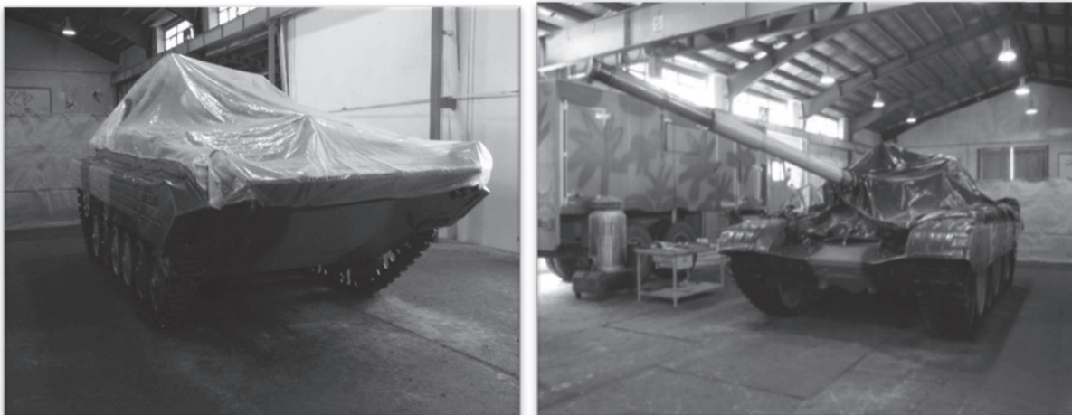
شکل ۳- انبارش بلندمدت دستگاه زرهی نفربر (در سوله یا زیر چادر برزنتی) به روش نیمه چادر
